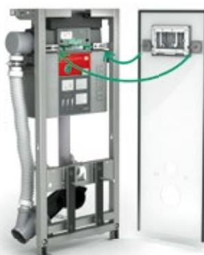
Kombinierbar ist das Air-WC-Element Mondo mit der Flächenbetätigung MEPA Mondo. Die elegante Glasplatte in Weiß wird einfach auf die Gewindebolzen zur Befestigung der Keramik direkt am WC-Element aufgeschoben und anschließend an den oberen Magnetaltern fixiert.
