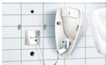
Ein Microcontroller kombiniert die Messwertänderungen für Leitwert und Füllhöhe und erkennt zuverlässig das Ende der Benutzung. Nach der eingestellten Verzögerungszeit wird die Spülung ausgelöst. Die Elektronik erkennt auch ein Austrocknen bzw. Verstopfen des Siphons und reagiert entsprechend.
